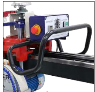
دستگیره ارگونومی جهت راحتی و تسلط کاربر در هر دو طرف دستگاه
