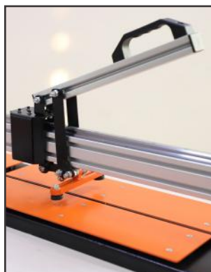
سینی فلزی فنی جهت قطع کردن راحت تر خط الماسه
