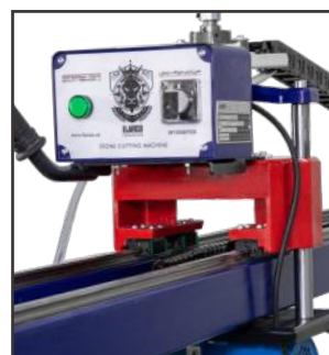
سیستم حرکتی لاینر گاید (ریل و واگن) روان و دقیق
