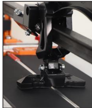
قطع کن سرامیک با امکان قطع کردن سرامیک های باریکتر
