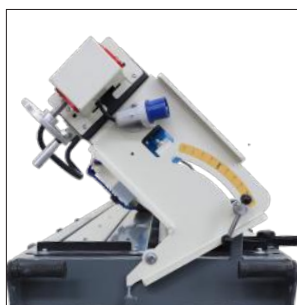
کله اسبی تقویت شده و مستحکم جهت افزایش دقت برش
