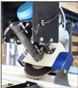
دارای گلویی انتقال قدرت جهت عمر و قدرت بالاتر الکتروموتور و نصب ابزارزن
