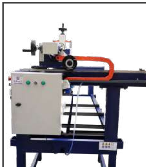
حرکتی طولی اتوماتیک قابل تنظیم با طول برش ۳۳۰ سانتی متر
