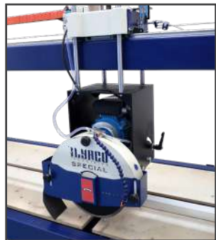
برش طولی اسلب‌های ۳ متری سنگ و سر امیک به صورت اتوماتیک
