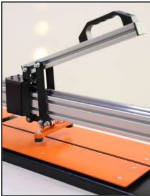
سینی فلزی فنری جهت قطع کردن راحت تر خط الماسه
