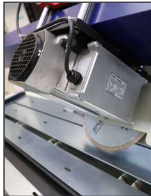
موتور پر قدرت ایتالیایی ۳ اسب ۲۸۰۰ دور بر دقیقه
