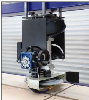
کلویی انتقال قدرت و قابلیت گردش صفحه موتور به وضعیت ۹۰ درجه به وسیله گیربکس
