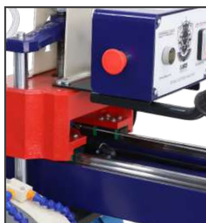
سیستم حرکتی لینیر گاید (ریل و واگن) روان و دقیق
