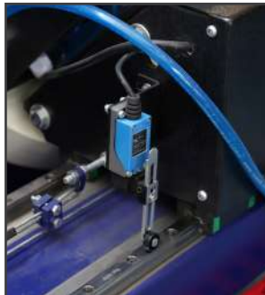
مجهز به میکرو سوئیچ جهت حرکت اتوماتیک
